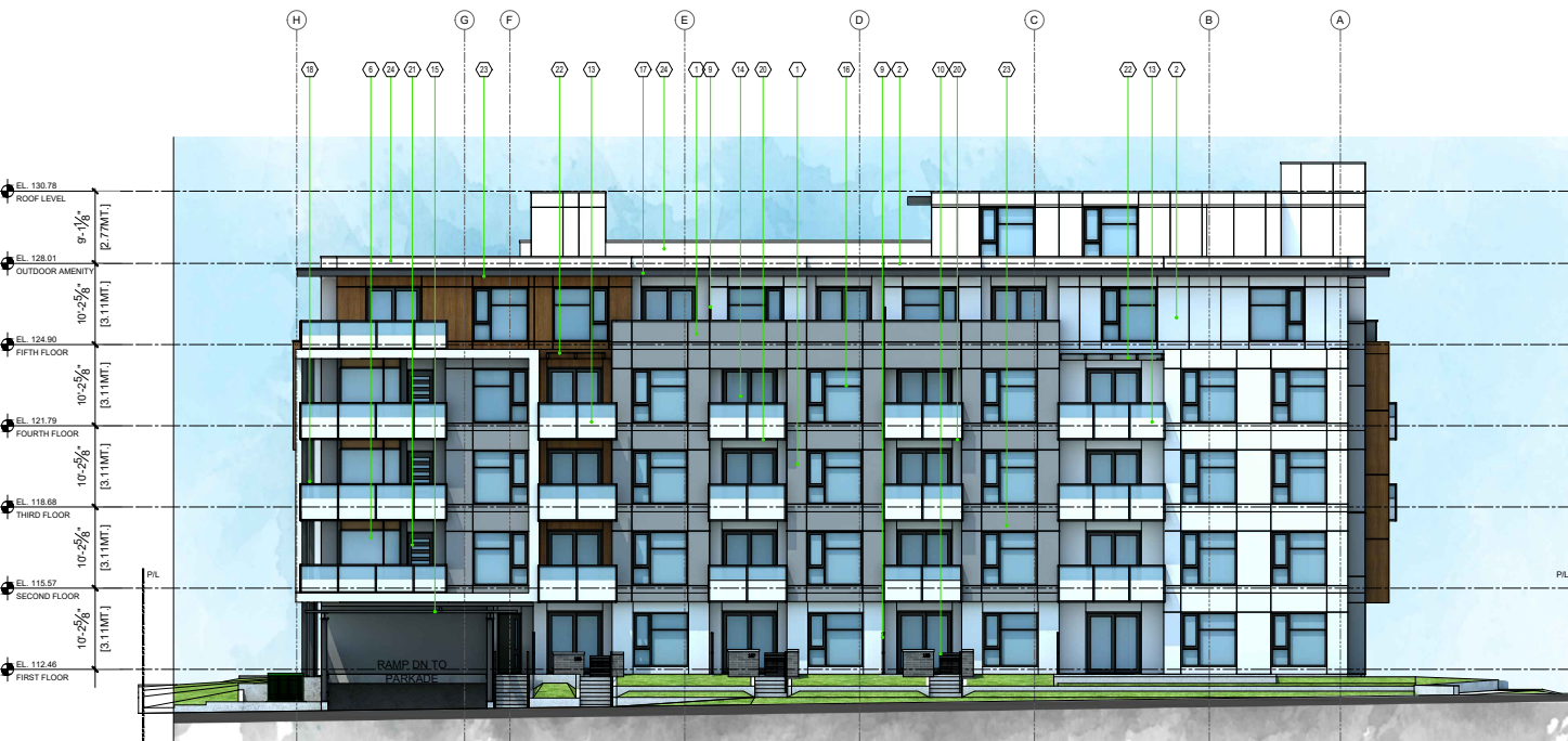
3 NORTH ELEVATION - (LANE) SCALE: 1/8" = 1'-0"
